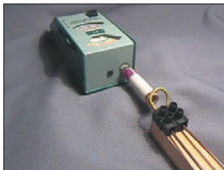
Figure 4: Couplage du grid-dip à la ligne.
