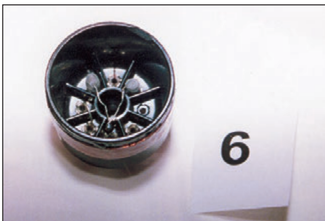
6 - Bobinage avec les deux capas Cc supplémentaires.
