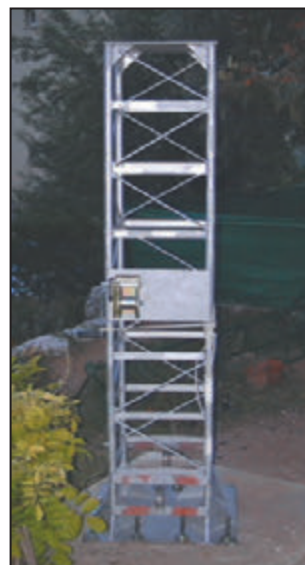
Photos 12 et 13 : Détail du support poulies et treuil sur le contre-pylône.
