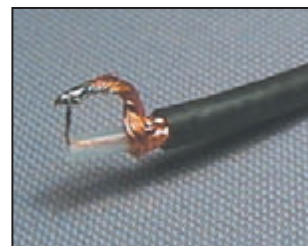
Photo 1 : La ligne est en court-circuit à un bout.
