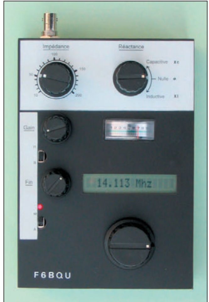
Figure 6 : L'analyseur d'antennes terminé
