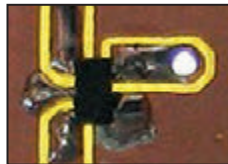
Figure 11: La soudure du LTC1799!
