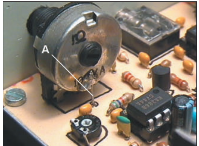
Figure 6: Fixation du potentiomètre R3 sur le circuit.
