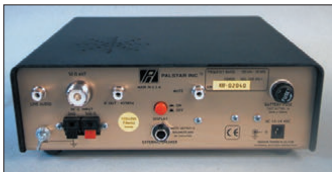
5 - Le panneau arrière. Notez la présence de la sortie FI...
