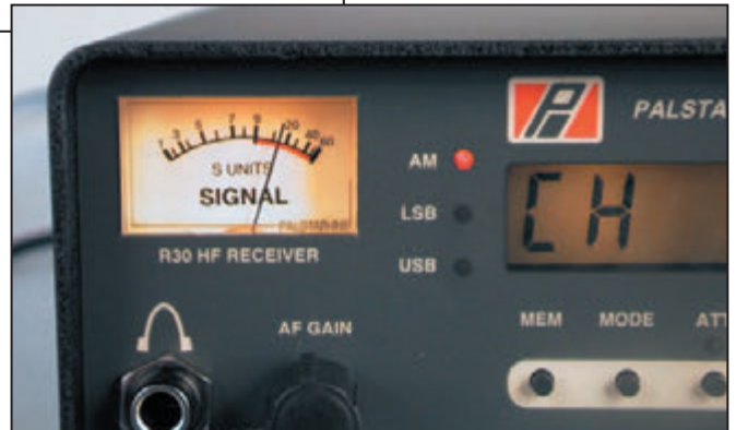
3 - Un S-mètre analogique lisible. Notez, sur le LCD, l'affichage en mode "MEM".
