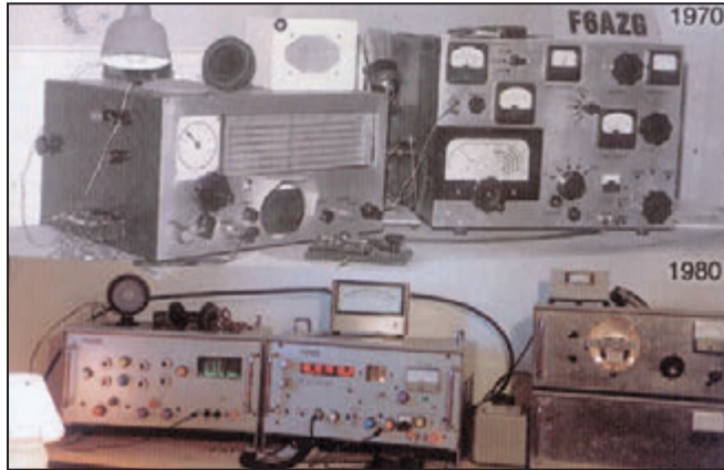
Les stations "OM" de Guy F6AZG : celle de 1970 fonctionnait en AM et CW, celle de 1980 en BLU et CW. Les deux récepteurs possèdent une visio panoramique... Deux superbes réalisations !
