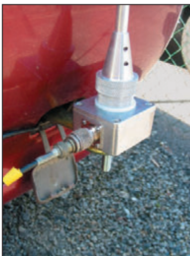
3 - Mise en place de l'embase de l'antenne.
