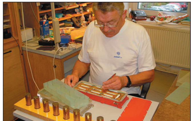
13 - Assemblage d'un module batterie.
