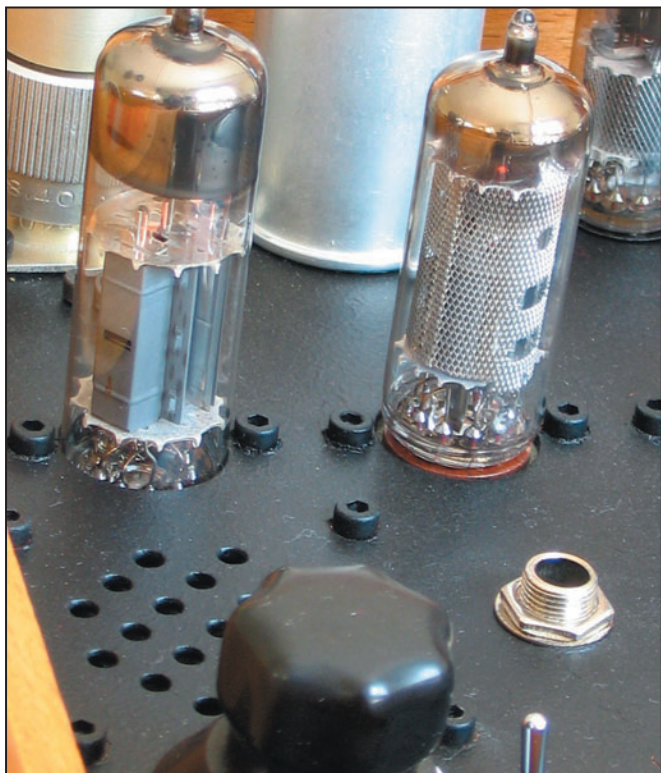
13 - L' ECL82 est encastré pour être au même niveau que les autres tubes.
