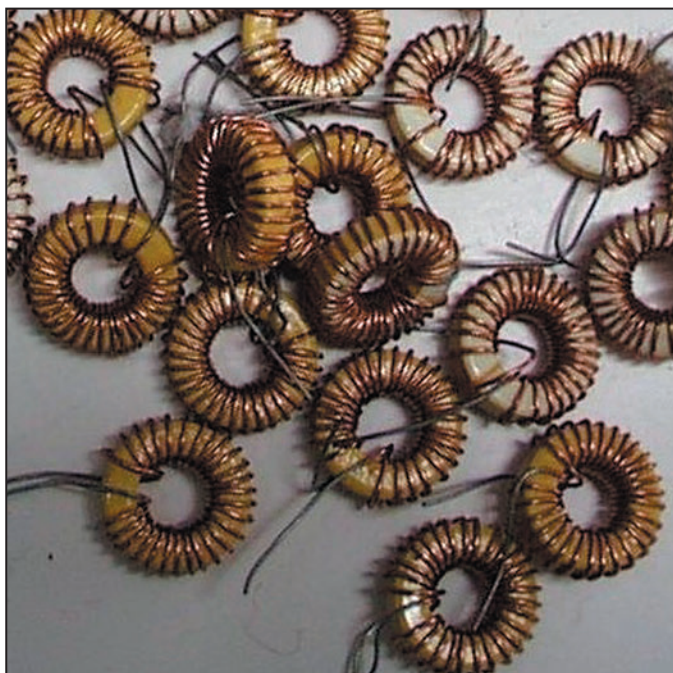
3 - Répartition homogène des spires sur le tore.
