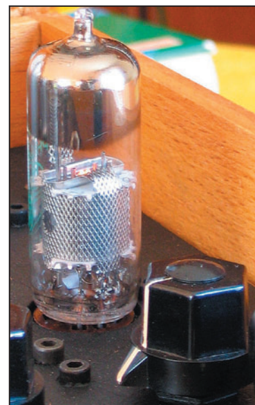
7 - La penthode à pente variable EF85 et le potentiomètre de gain HF.
