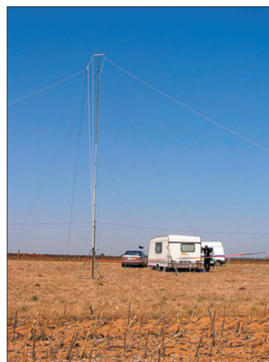
4 – Le mât et les antennes filaires.
