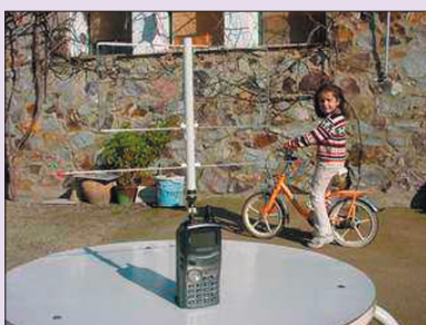
1 - L'antenne "CJU" de EA4CYQ montée directement sur le portatif.
