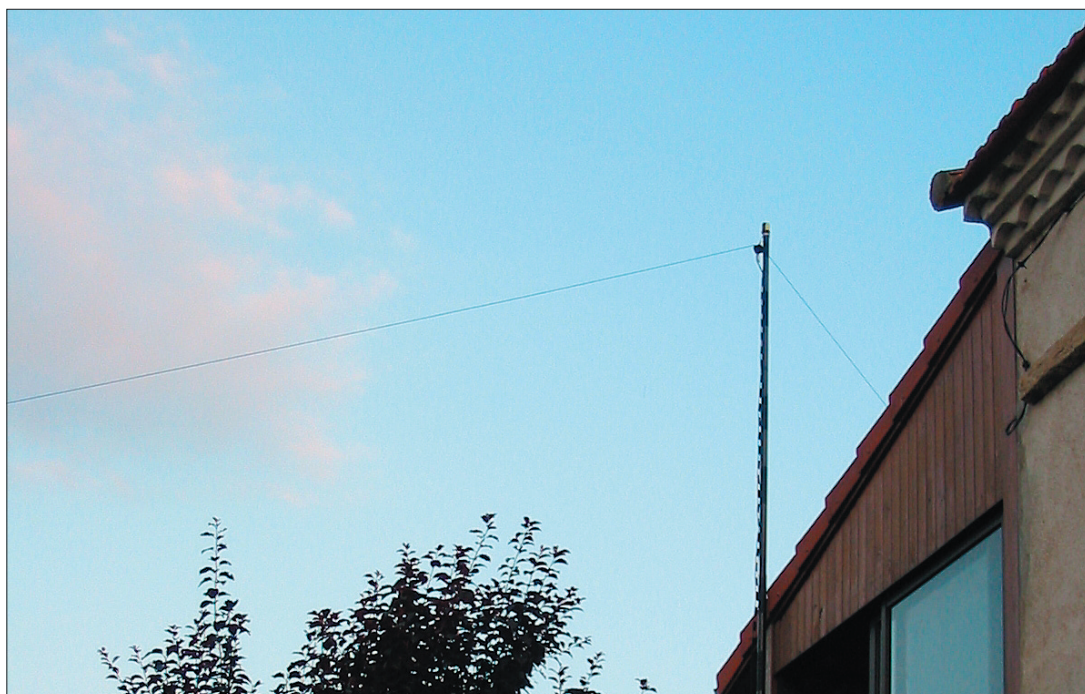
1 - Dipôle, l'antenne la plus simple qui soit (mais ici, c'est une center-fed alimentée par ligne 450 Ω).
