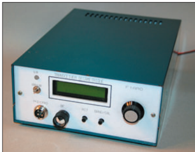
13 – Le transceiver décimétrique dans lequel le DDS est implanté.
