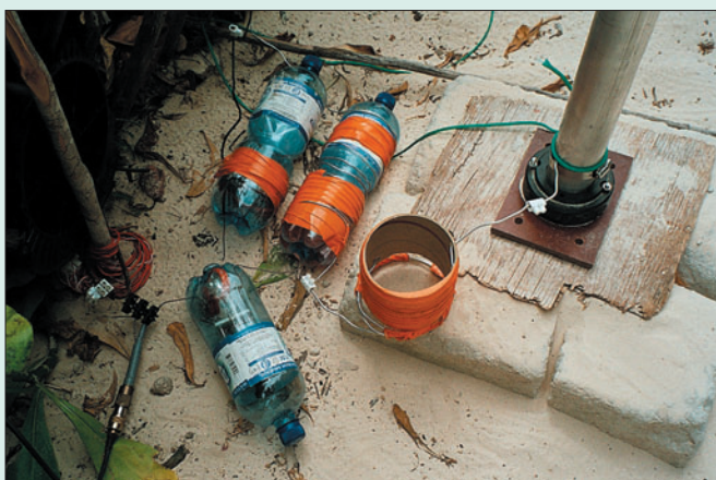
7 - La boîte d'accord étanche façon F6AML : ça tient le kW !
