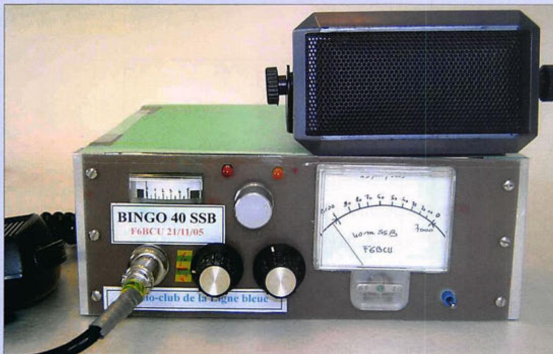
Cet article, dont la première partie est parue dans MEGAHERTZ magazine N° 285, décrit la construction, sans circuit imprimé, d'un émetteur-récepteur BLU pour la bande des 40 mètres.
