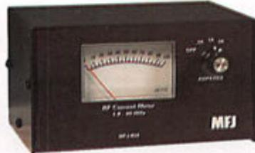
reil permettant de mesurer le courant dans la ligne d'alimentation de votre antenne. Cette mesure se fait sur 3 gammes calibrées (0,3, 1 et 3 A). En pratique, il vous permettra d'améliorer le transfert d'énergie en déterminant le réglage produisant un maximum de courant. Parmi les exemples d'utilisation possible, on citera la comparaison de différents coupleurs avec des surprises à la clé ! Alimentation en 12 V.
