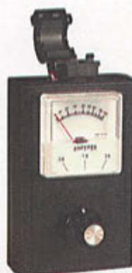
MFJ-853, un autre appareil de mesure du courant dans l'antenne. Celui-ci ne se monte pas en série dans la ligne mais dispose d'un "capteur" composé d'une
