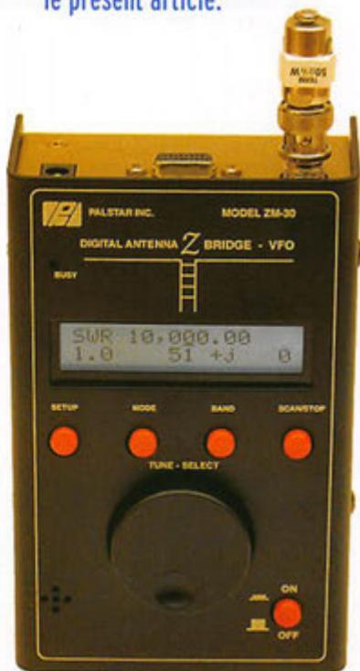
en analysant la variation d'impédance en son point d'alimentation en fonction d'une variation de fréquence, tout comme pour une self, un condensateur, un filtre LC, un adaptateur d'impédances LC, un transformateur HF, un balun, ou encore une ligne de transmission par exemple.
