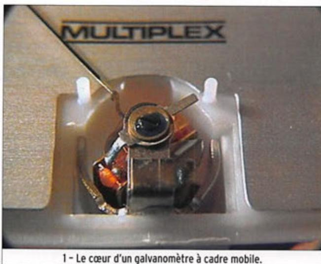
1 - Le cœur d'un galvanomètre à cadre mobile.
