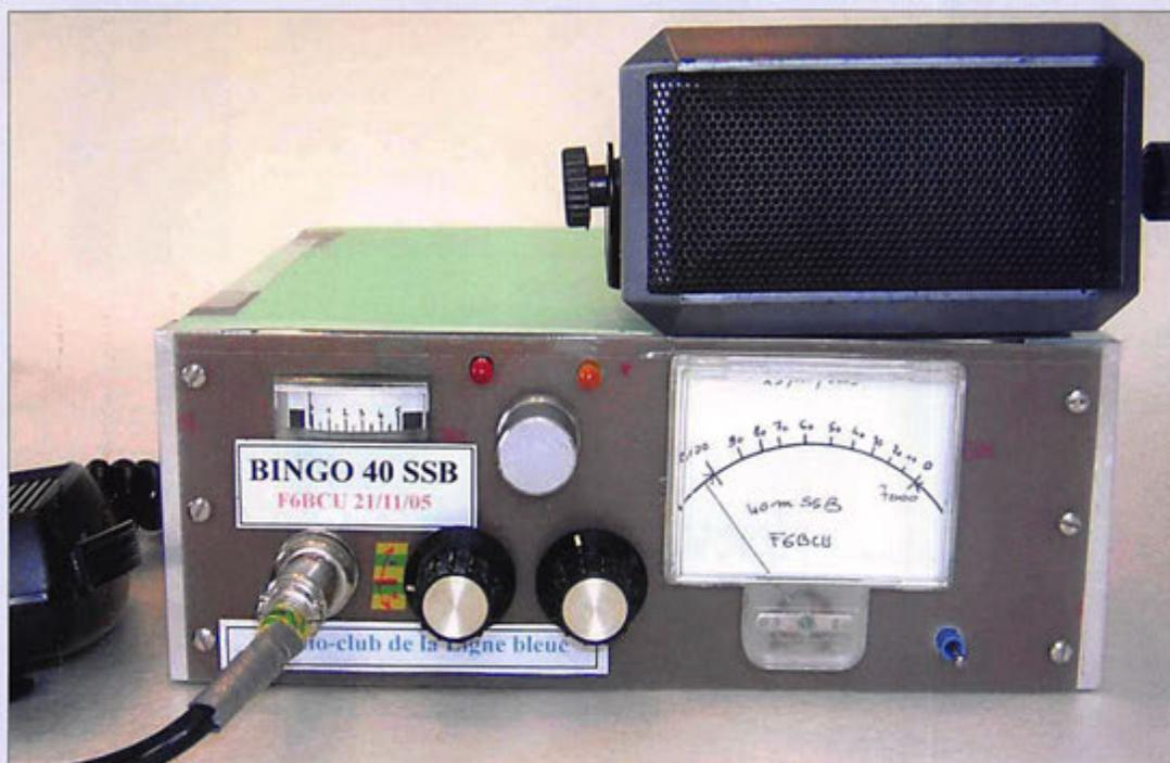
Cet article, dont la première partie est parue dans MEGHERTZ magazine N° 285, décrit la construction, sans circuit imprimé, d'un émetteur-récepteur BLU pour la bande des 40 mètres.
