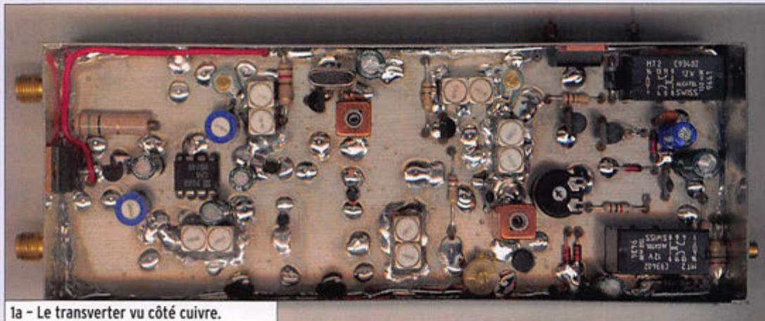
1a - Le transverter vu côté cuivre.
