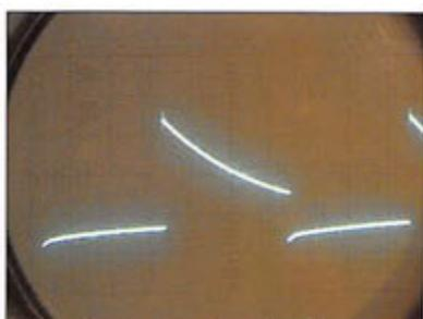
6 - Signal mesuré sur l'entrée d'une porte du 7400.
