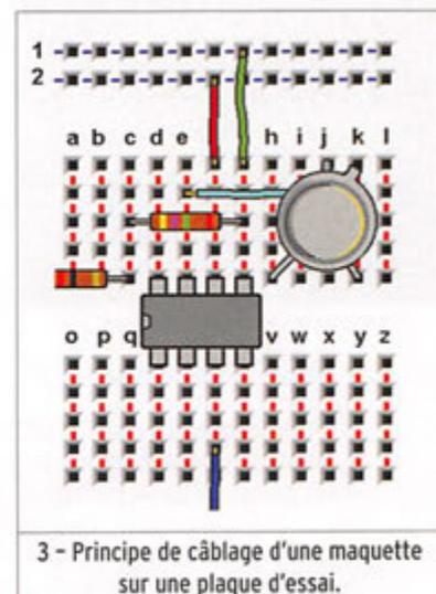
3 - Principe de câblage d'une maquette sur une plaque d'essai.
