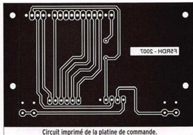
Circuit imprimé de la platine de commande.
