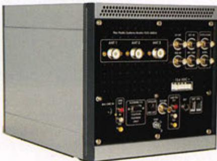
breux câbles et d'une carte son. Là encore, c'est à Visalia que l'appareil a été présenté, la photo reproduite ici nous montre la face arrière (la plus intéressante !) de ce transceiver qui, cerise sur le gâteau, fonctionne entièrement en duplex intégral (émission et réception séparées). Sa puissance de sortie est de 100 W, du 160 au 6 m. À découvrir sur [www.flex-radio.com](http://www.flex-radio.com)
