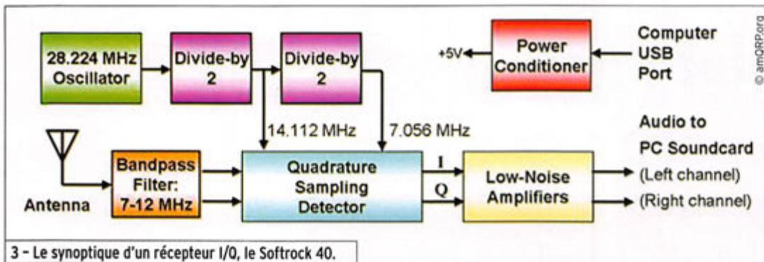
présent à l'antenne), délivrant 4 signaux, déphasés les uns par rapport aux autres de 90°, sommés deux à deux (0 et 180°, 90 et 270°) pour fournir respectivement les voies I et Q (photo 2).
