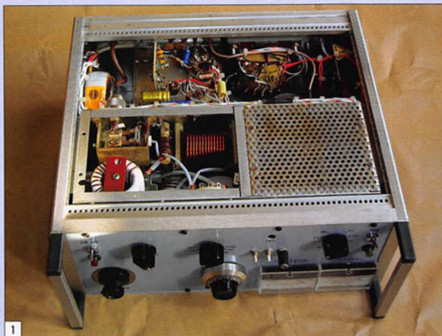
Les tétrodes céramiques de la série 4CX250, faciles à trouver à vil prix dans les brocantes OM, permettent l'élaboration relativement facile d'amplificateurs linéaires pouvant couvrir la plupart des bandes amateurs du 1,8 au 432 MHz. Ces tubes sont toutefois assez difficiles à alimenter correctement, car leur grille écran présente des caractéristiques assez spéciales qui influent beaucoup sur la stabilité, la sécurité du tube et la linéarité de l'amplificateur.
