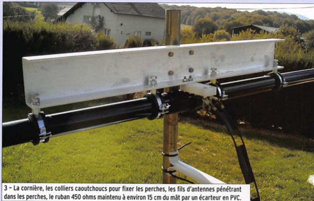
3 - La cornière, les colliers caoutchoucs pour fixer les perches, les fils d'antennes pénétrant dans les perches, le ruban 450 ohms maintenu à environ 15 cm du mât par un écarteur en PVC.
