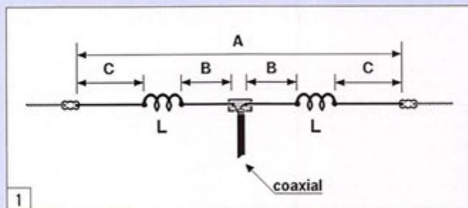
de l'antenne et de l'endroit où la bobine est placée sur celle-ci. Un dipôle raccourci peut être vu comme l'association de deux antennes mobiles identiques, chaque brin ayant sa propre bobine.
