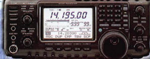
Emetteur-récepteur HF, 50 et 144 MHz, tous modes. DSP FI 32 bits, keyer et coupleur automatiques intégrés, démodulateur RTTY, large écran LCD, 102 mémoires, puissance de 100 W, etc...
