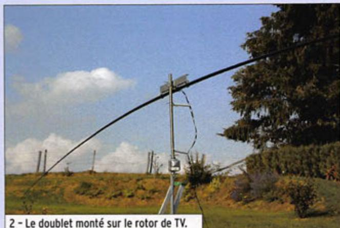
2 - Le doublet monté sur le rotor de TV.
