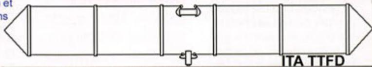
L'antenne **ITA TTFD** est un dipôle replié sur une résistance de charge non inductive. Elle fonctionne de 1,5 à 30 MHz en continu avec un ROS n'excédant pas 3:1 (1:1 avec boîte de couplage). La **ITA TTFD** est peu sensible aux parasites électriques et autres "bruits de fond". L'installation est possible à l'horizontale ou en "sloper". Fonctionne sans réglage, connecteur SO-239, longueur : 22 m et puissance max. : 800 W PEP.
