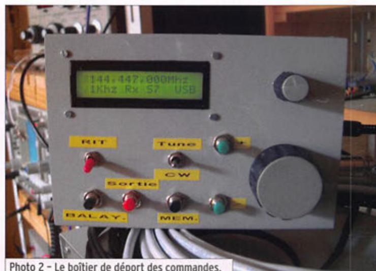
Photo 2 - Le boîtier de déport des commandes.
