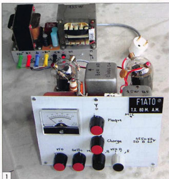
**D**eux mots sur la 815... Dans une même ampoule, en culot octal, on trouve l'équivalent de deux 6L6. Elle monte à 150 MHz, elle peut sortir entre 50/75 watts et bon nombre d'émetteurs VHF sol en étaient équipés. Elle a été remplacée aujourd'hui par la 829B. Pour le chauffage, elle peut être alimentée en 6 ou 12 V. Compte tenu du stock des armées américaines, on en trouve encore beaucoup et à un prix attractif : entre 5 et 15 euros sur Internet, anciennes mais neuves.
