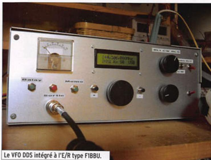
cette dérive qui semble très importante, je n'ai pas noté de dérive après quelques minutes de fonctionnement, même après le multiplicateur par 6. Quant au bruit de phase en sortie du DDS (non mesuré), il devrait être réduit de 14 dB par rapport à celui du signal d'horloge suivant le calcul  $20 \log (F \text{ Horloge} / F \text{ sortie})$ .
