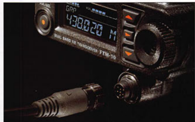
9 - Dispositif de montage du micro optionnel sous la face avant (© Yaesu).
