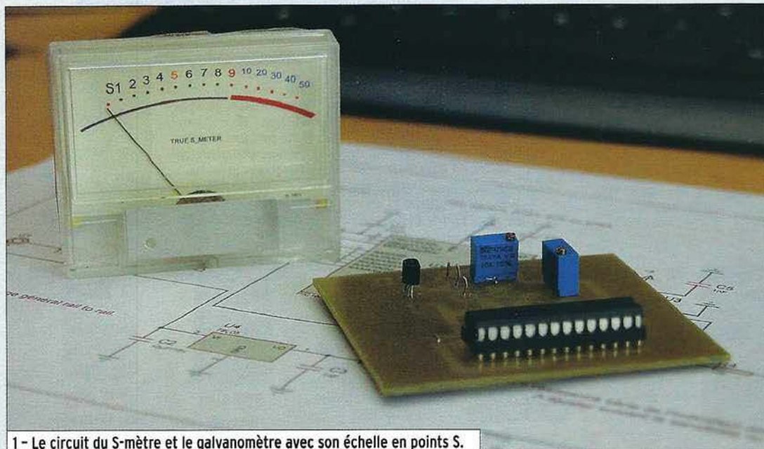
1 - Le circuit du S-mètre et le galvanomètre avec son échelle en points S.
