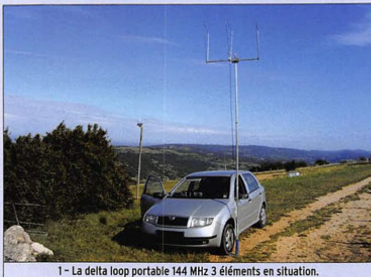
1 - La delta loop portable 144 MHz 3 éléments en situation.
