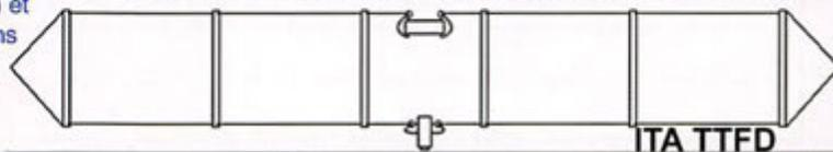
L'antenne **ITA TTFD** est un dipôle replié sur une résistance de charge non inductive. Elle fonctionne de 1,5 à 30 MHz en continu avec un ROS n'excédant pas 3:1 (1:1 avec boîte de couplage). La **ITA TTFD** est peu sensible aux parasites électriques et autres "bruits de fond". L'installation est possible à l'horizontale ou en "slopper". Fonctionne sans réglage, connecteur SO-239, longueur : 22 m et puissance max. : **269 €** 800 W PEP.
