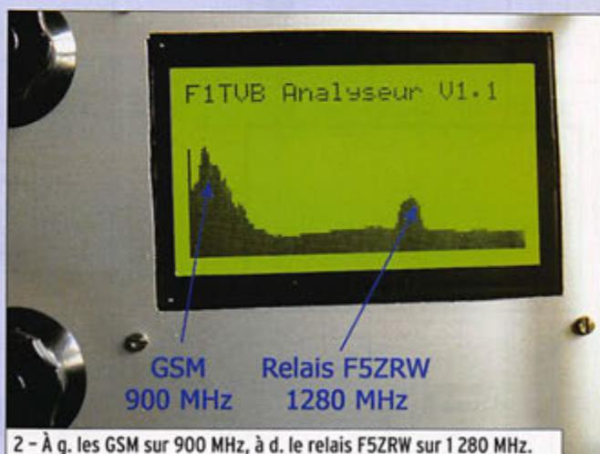
2 - À g. les GSM sur 900 MHz, à d. le relais F5ZRW sur 1 280 MHz.
