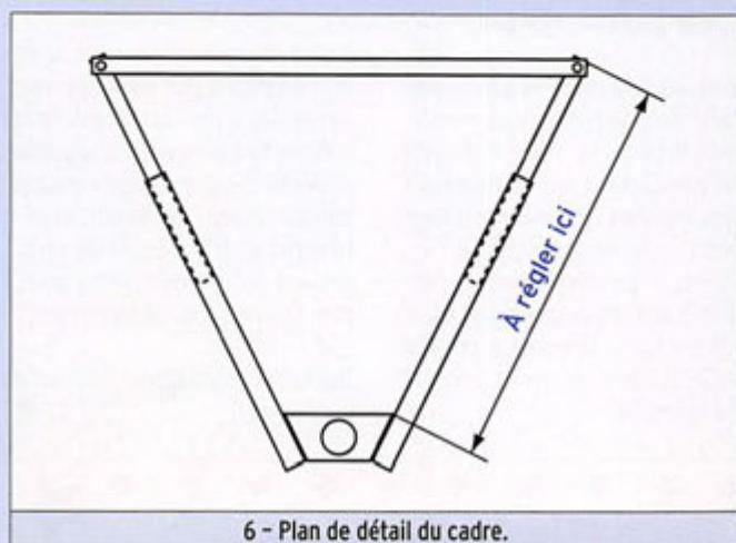
composé de tube de 10 mm à la base et, sur le haut, c'est du 8 mm qui coulisse dans la partie inférieure pour en régler la longueur.
