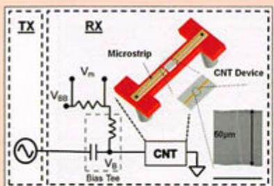
Deux chercheurs américains ont réalisé un poste de radio en utilisant comme démodulateur un nanotube de carbone. Des dispositifs bien plus complexes, comme des nanomachines injectables dans un organisme, pourraient un jour être équipés d'un émetteur radio.
