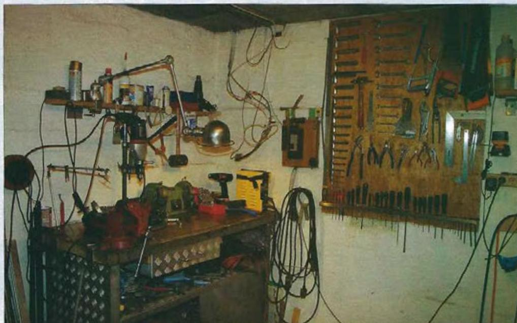
Vue partielle de l'atelier de l'auteur. La structure de l'établi est en cornières inox, ainsi que la visserie d'assemblage, le reste en plaques d'aluminium, le tout est facilement démontable.
