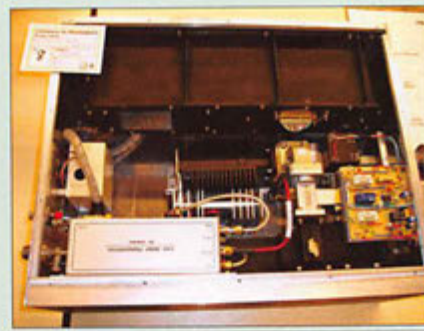
5 - Transverter 70/3 cm, 50 W HF, par F5BUU.
