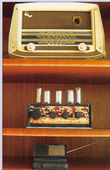
8 - Du poste TSF à tubes au récepteur OC haute intégration...
