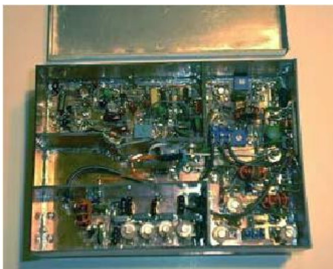
Generador de BLU terminado. Una tapa de aluminio cubrirá la caja.
