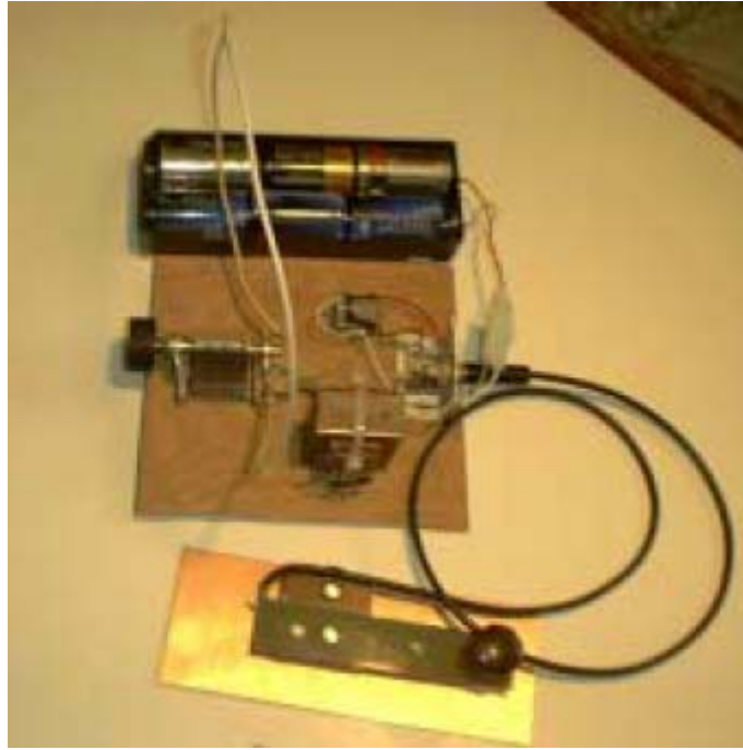
Transmisor de chispa para 10 metros.
