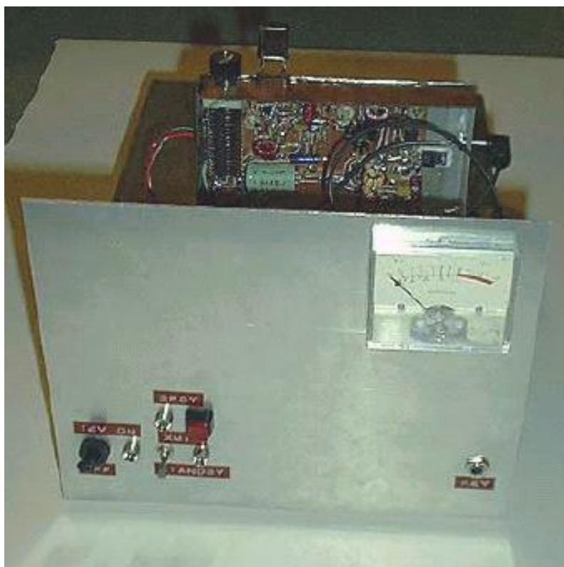
La “unidad central” transmisora, es una caja que contiene tus módulos de transmisión.
