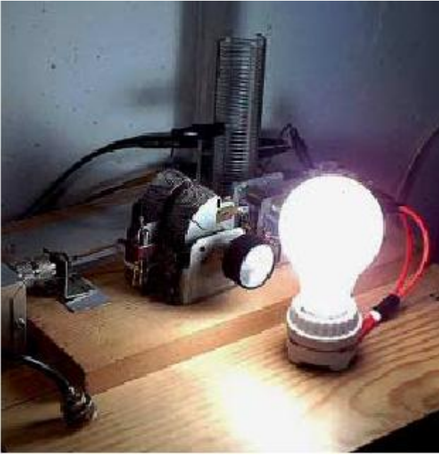
Bombillas usadas como cargas resistivas
