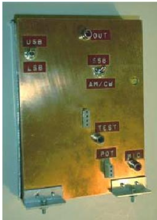
El generador de BLU de 9 MHz visto desde el lado de control
