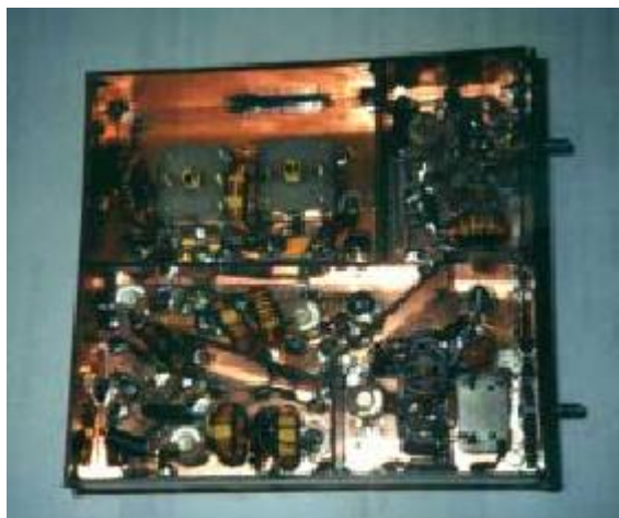
Este módulo contiene conversores para 160 metros y 17 metros.
