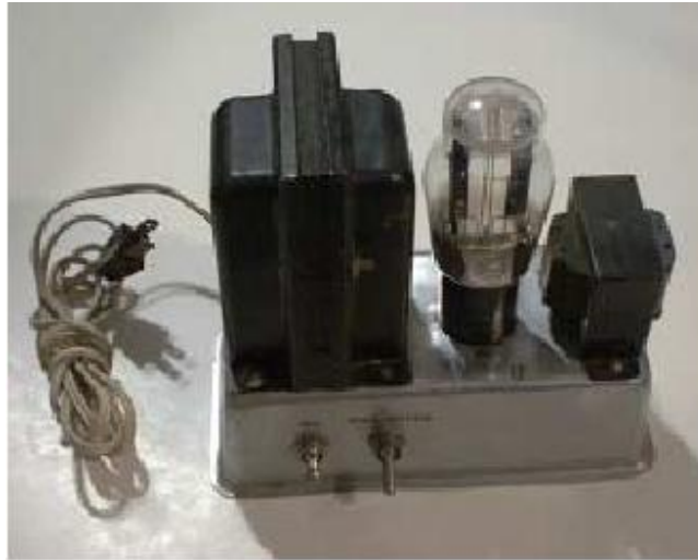
Una fuente de alimentación hecha de partes salvadas de una vieja radio
