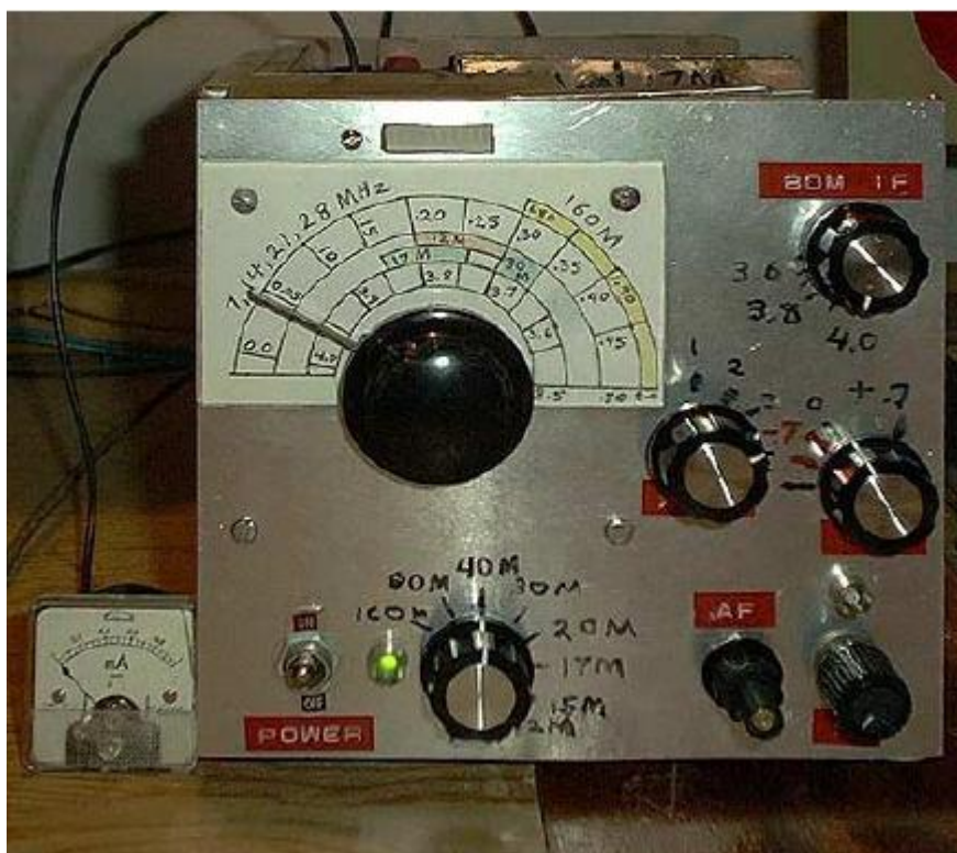
Receptor de conversión doble multibanda de HF de radioaficionado de construcción casera
