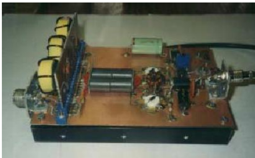
El amplificador lineal de 50 vatios.
