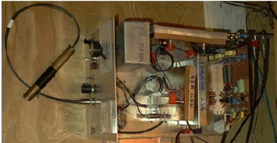
Transmisor BLU de construcción casera
