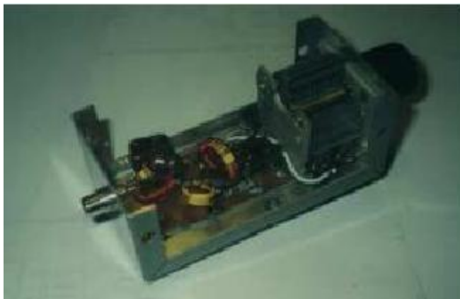
El preselector está construido en una cajita instalada detrás del panel frontal
