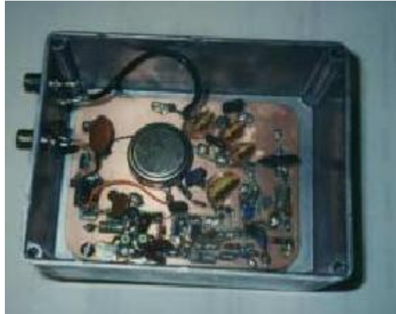
Un VFO de sintonía con varicap. La sintonía se consigue con el potenciómetro redondo grande
