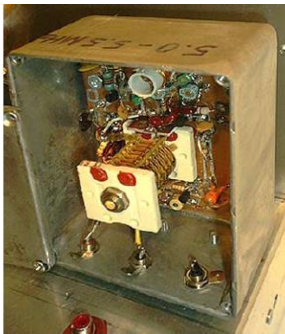
Un OFV de 5 MHz sintonizado con un condensador variable mecánico
