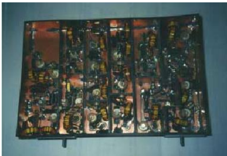
Módulos conversores para 20 metros, 30 metros, 40 metros y 12 metros.
