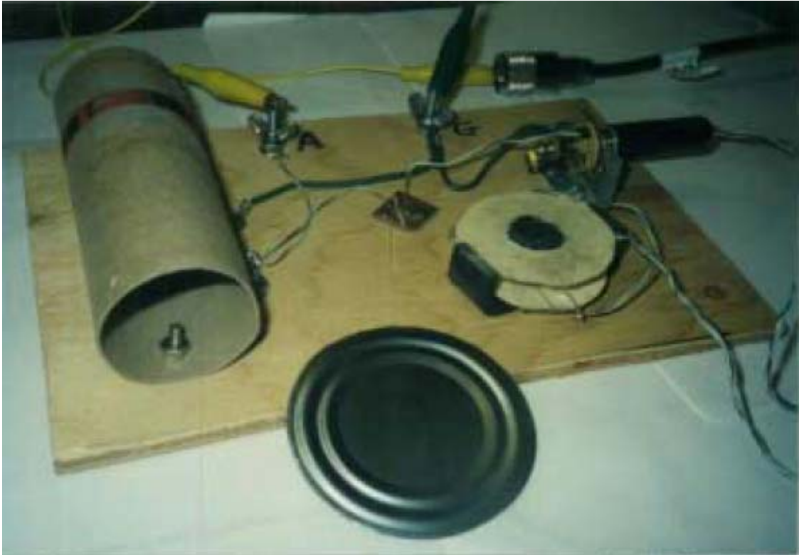
Receptor de radio a cristal mostrándose el auricular auto construido. Se ha quitado el diafragma metálico.
