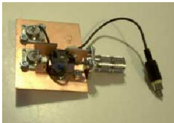
Relé de antena de construcción casera
