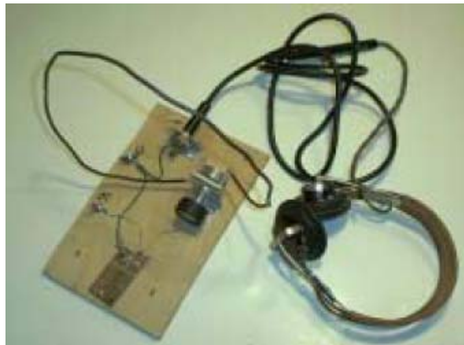
Receptor de radio a cristal para 10 metros.
