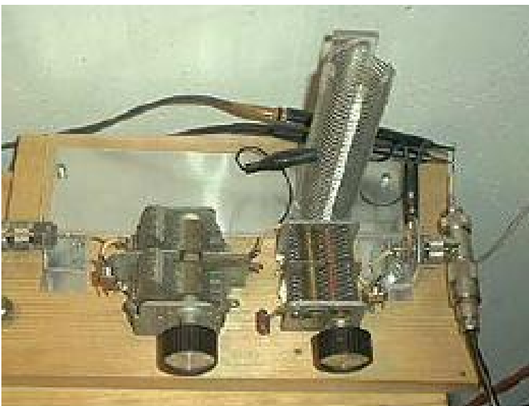
El acoplador en T monitorizado por un osciloscopio y un frecuencímetro
