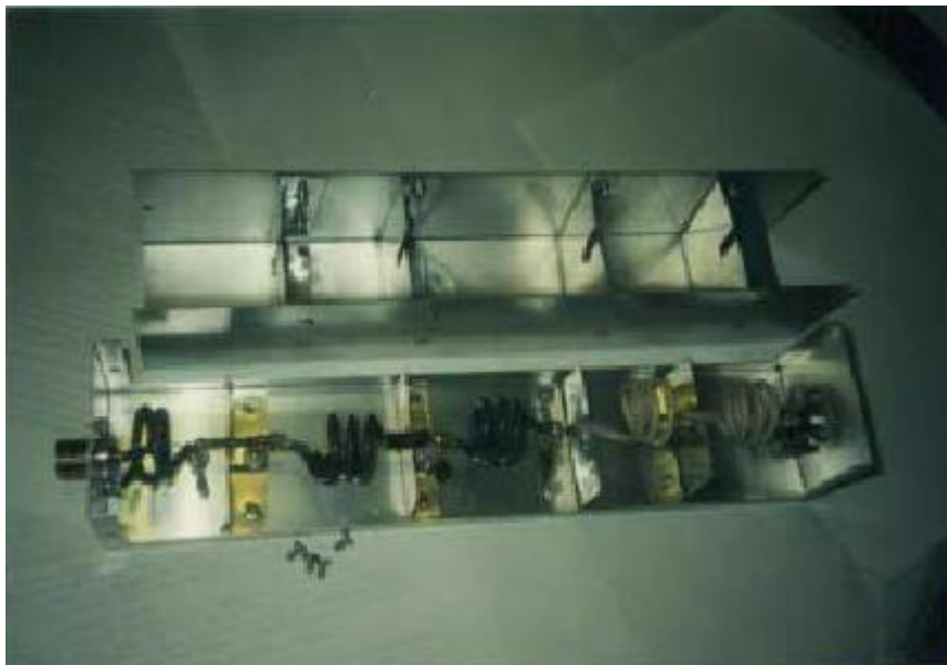
Vista interior del filtro. Cada bobina está aislada de sus vecinas por particiones
