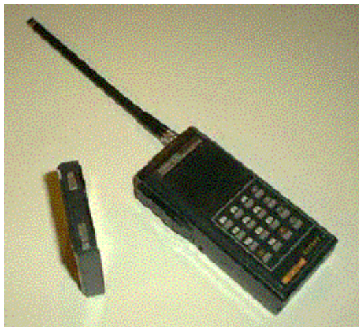
Un transceptor de mano para 2 metros (walkie-talkie) con paquete de baterías separado.
