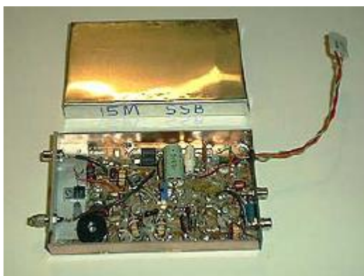
Un módulo excitador de 21 MHz. La tapa de la caja está sobre la placa.
