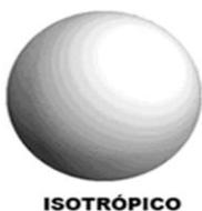
Recordemos que la antena isotrópica es una antena utópica, de pura teoría, y que sirve como referencia CERO dB para antenas más complejas. Esta antena radiaría EN TODAS DIRECCIONES POR IGUAL, y nos viene bien la semejanza con un globito esférico.
