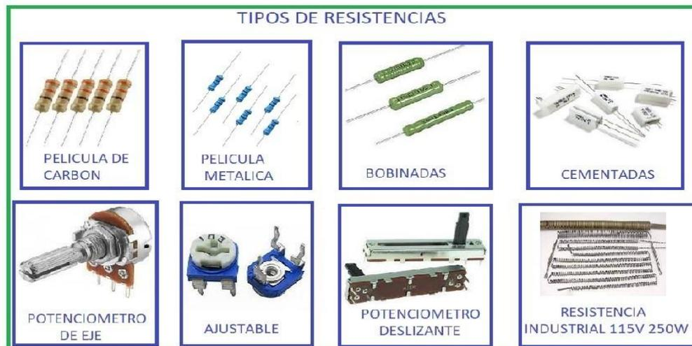
Este componente, importantísimo en aplicaciones eléctricas y electrónicas, es, junto con el condensador, el que más veces vamos a encontrarnos en cualquier circuito. La resistencia es, como su nombre indica, un componente que presenta una RESISTENCIA al paso de la corriente eléctrica. Este funcionamiento trae siempre como consecuencia un desprendimiento de calor, que las más de las veces, no nos interesa, salvo que la diseñemos exprefeso.
