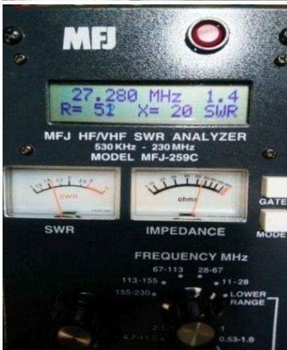
Ya sabes que la Resistencia de radiación, junto con la Parte Reactiva, forman la Impedancia, (Z), que el analizador compara con la referencia interna de  $Z=50$  Ohmios, y te da el valor de la ROE.-
