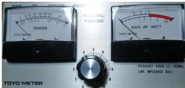
mundo sabe de lo que se trata. Es un aparato, o dispositivo, que hace una medición comparativa entre la energía que sale del emisor, (potencia directa) y la que devuelve la antena hacia la línea, (potencia reflejada). El aparato ya va calibrado
