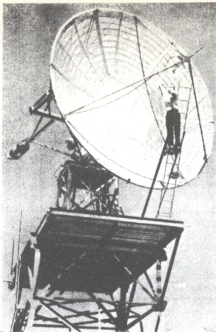
Paul Wilson, W4HHK, trabajando en el plato de 18 pies (5,48 m) empleado para realizar medidas de ruido solar en 432 Mc/s. El elemento director y su reflector circular plano quedan justamente encima de la cabeza del autor.
