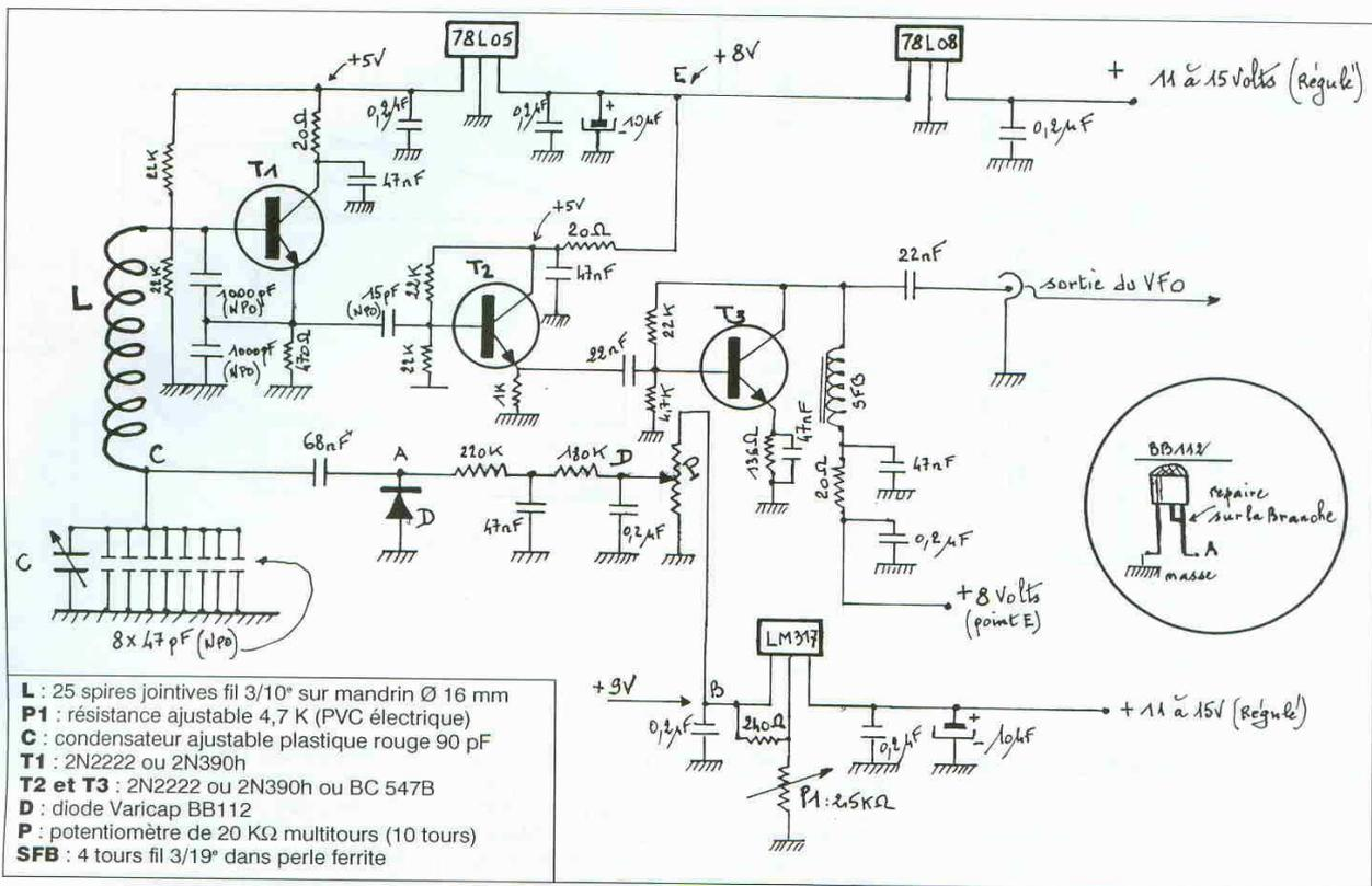
Figure 1. V.F.O. (Oscillateur à fréquence variable) 3,5 à 4 Mhz.
