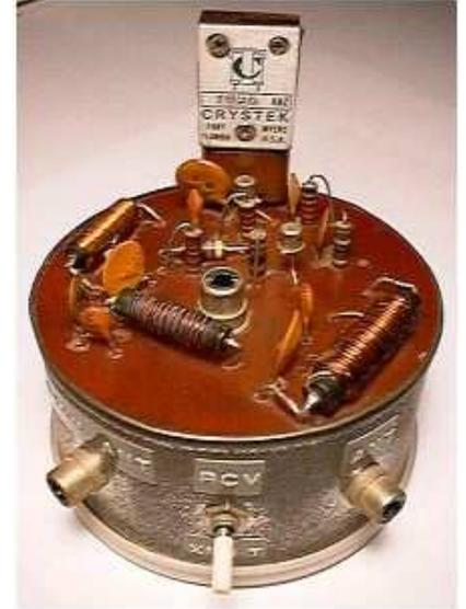
Ce petit émetteur a été construit dans les années 1976 par W1FB Douglas De Max ; la description en a été présentée dans la revue QST de l'ARRL de la même époque. Ce petit émetteur piloté quartz fait encore fureur de nos jours aux USA. Des adeptes du QRPp continuent sa construction. Sa puissance est de l'ordre de 350mW HF sur 40 mètres.
