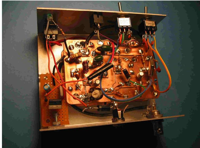
Simple et astucieuse, voici encore une version moderne du TUNA TIN 2 . Le coffret est construit en bakélite ou époxy cuivré facile à souder.
