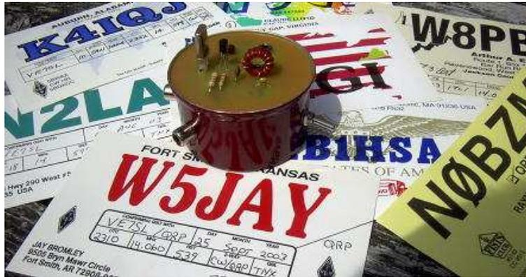
Le Micronaut est un petit émetteur développé par Dave Ingram K4TWJ qui a fait l'objet de plusieurs publications. VE7SL a repris cette construction et l'a dénommée MINI TUNA. Cet émetteur piloté quartz utilise un unique 2N2222, la puissance de sortie est d'environ 100mW HF. Son fonctionnement est assuré de 2 à 18 volts. Il a été construit sur la bande des 20m et depuis janvier 2005, 33 pays ont été contactés, postuler pour le W.A.S est une possibilité avec ce mini-émetteur.
