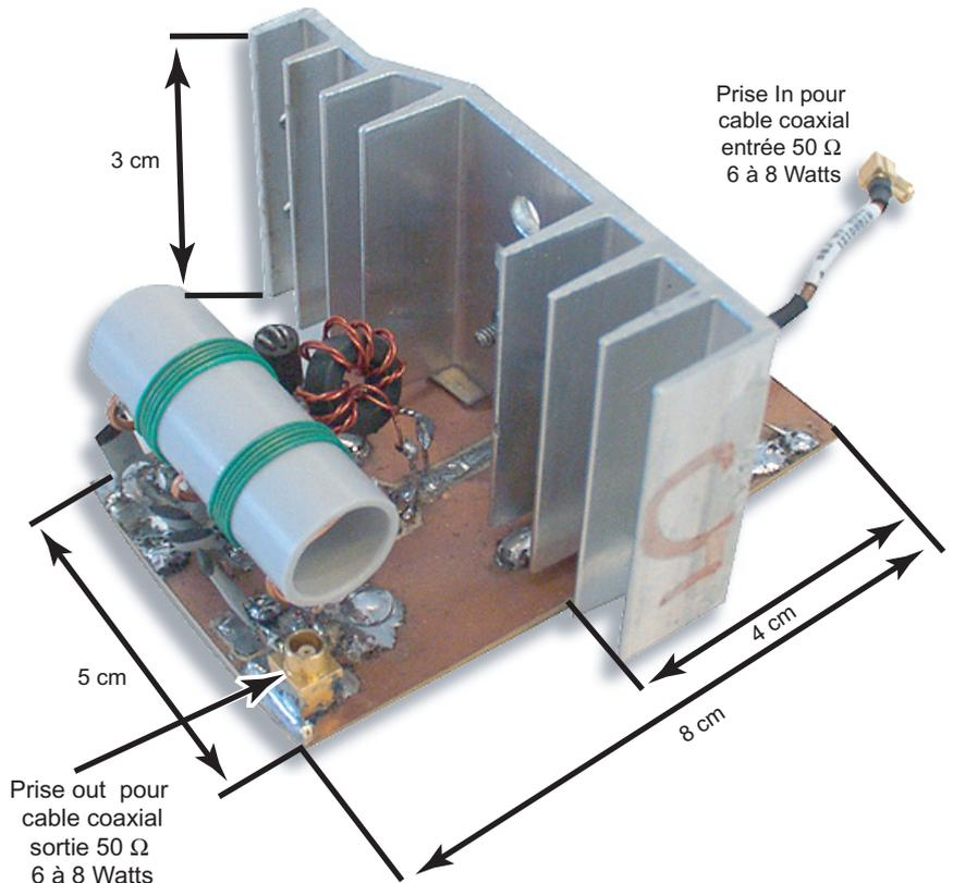
**Figure 6** Construction Pratique du PA 6-8 Watts
