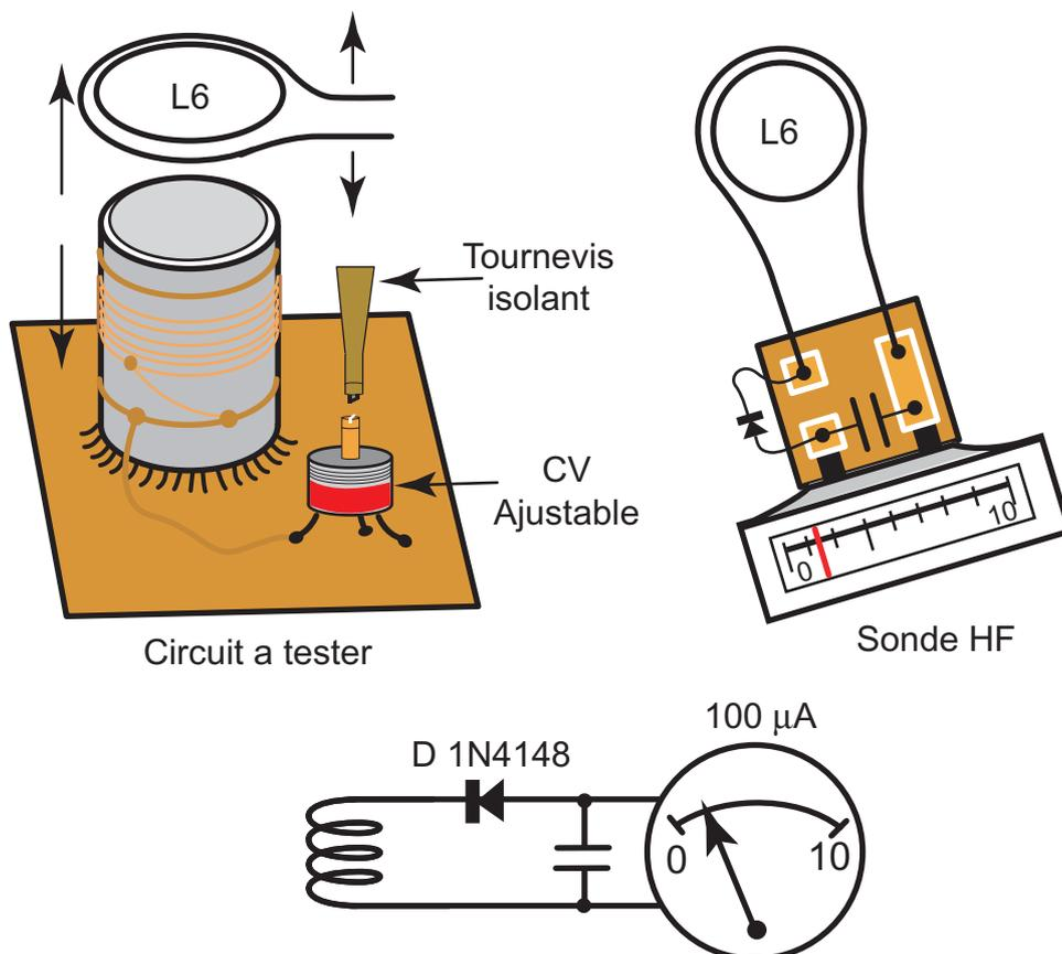
Figure 7 Mesure avec sonde HF OM
