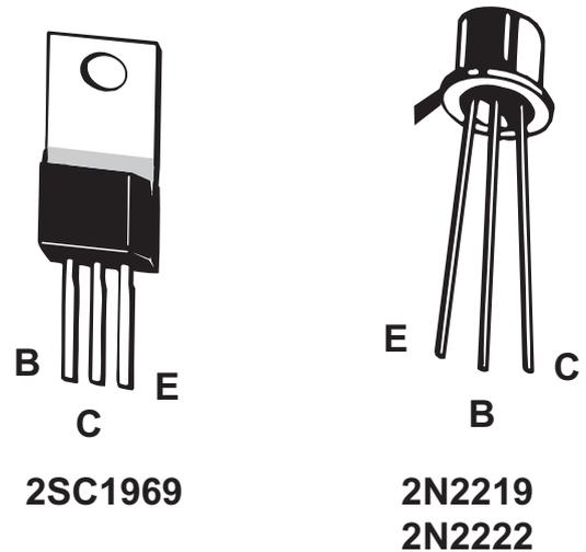
**Figure 8** Brochage des Transistors
