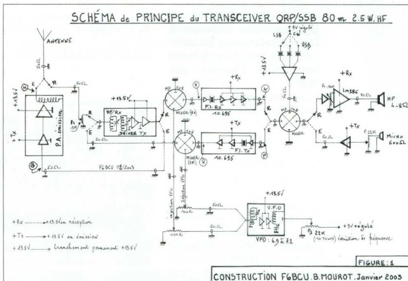
fonctions avec une judicieuse commutation par relais 2/RT -12volts évitant toute réaction d'accrochage. A ce poste clé de la commutation les diodes sont proscrites par leur mauvaise isolation qui fait que le montage : se mort la queue et auto-oscille en émission. A l'usage le relais présente la meilleure isolation en HF.
