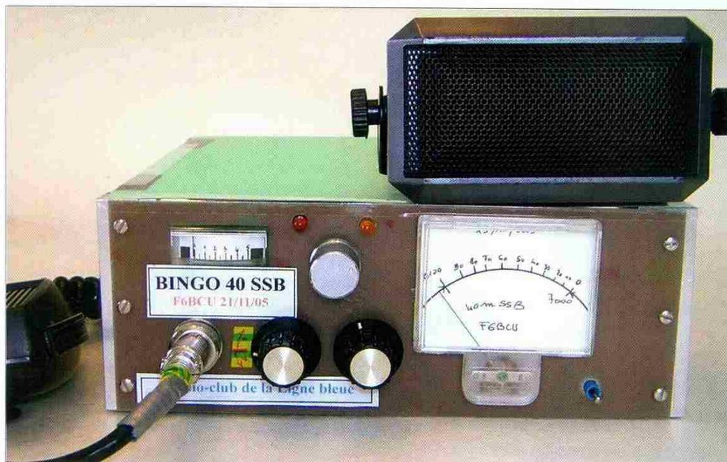
Cet article, dont la première partie est parue dans MEGHERTZ magazine N° 285, décrit la construction, sans circuit imprimé, d'un émetteur-récepteur BLU pour la bande des 40 mètres. Vous trouverez ici la 5e et dernière partie.
