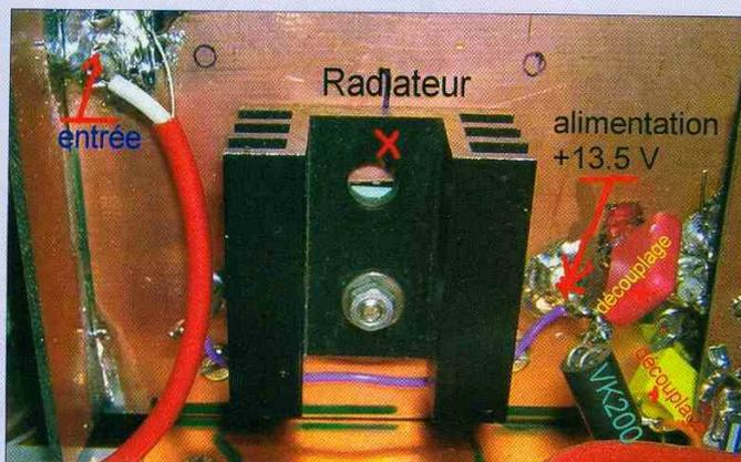
Photo 19 - PA 2 W HF côté radiateur.
