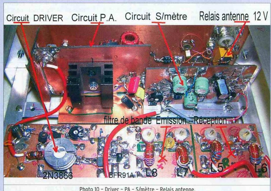
Photo 10 - Driver - PA - S/mètre - Relais antenne.
