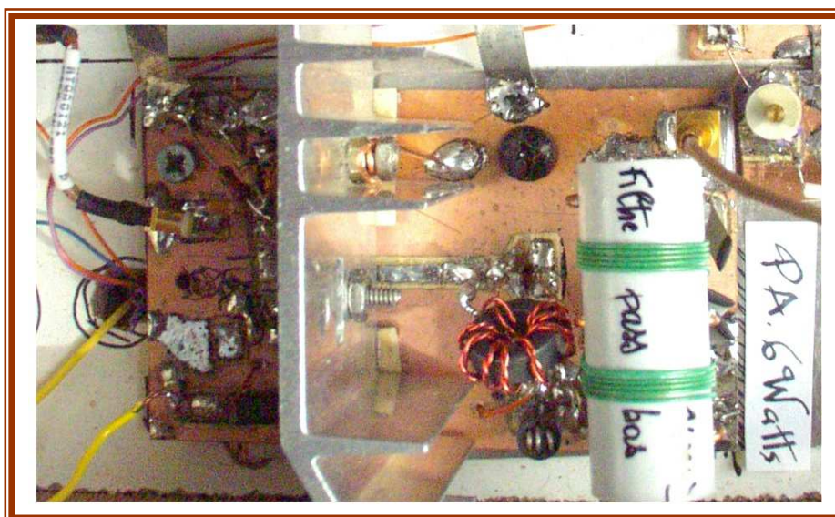
Photo vue de dessus du PA 6 watts HF
