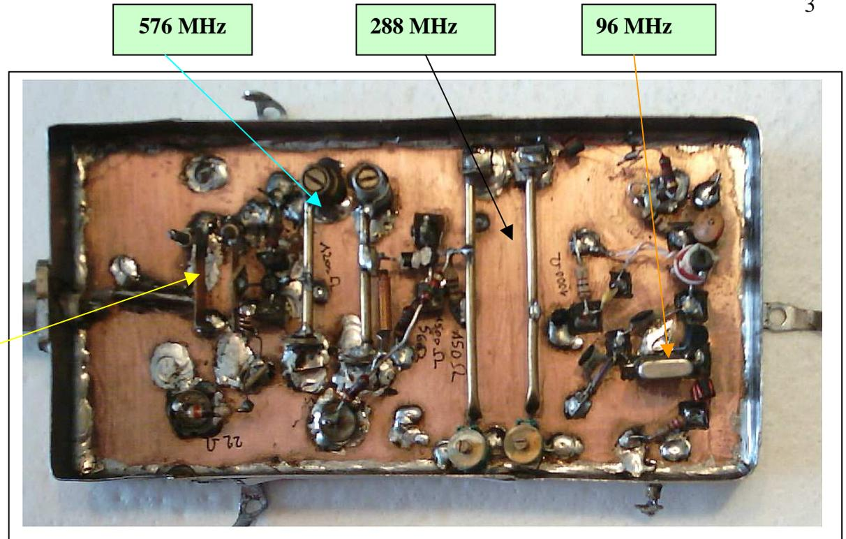
Chaîne oscillatrice 1152 MHz N°2 construite pour driver une balise 10GHz.
