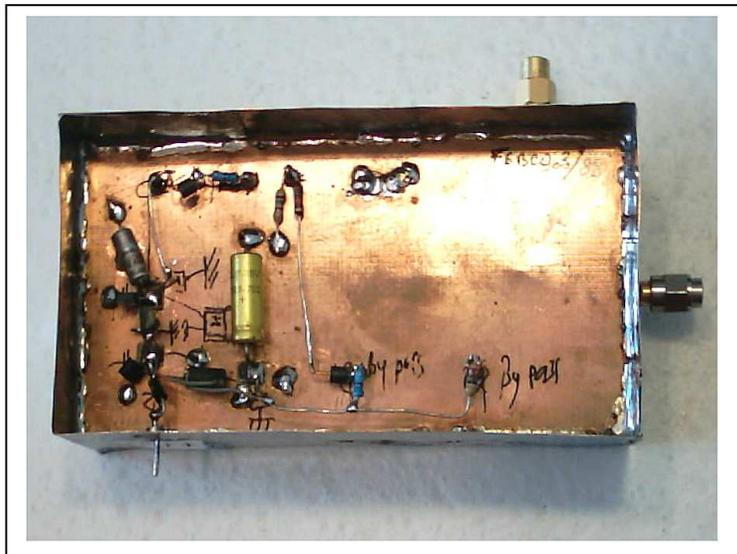
Chaîne oscillatrice 1152 MHz N°1 construite en 1986, technique du montage direct en l'air facile à mettre au point et à modifier
