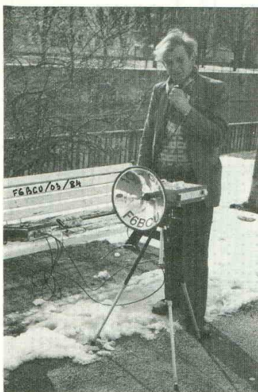
PHOTO 4. Notre correspondant pour la 1 re liaison 10 GHz FM bande étroite. F1HDT le 4 mars 84 TX/RX F.I. 29 MHz + AFC + récepteur auxiliaire NBFM 29 MHz
