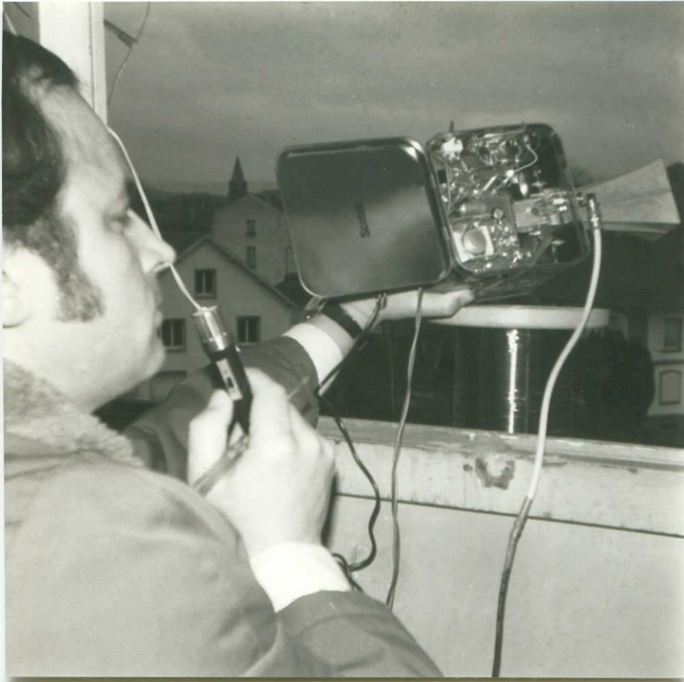
1 er Auto-mélangeur 10GHZ 1979 liaison sur 300 m avec F6FJZ
