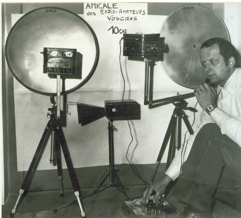
Mélangeurs à diodes 1ère liaison le Hohneck 88 à Colline de Sion 54 sur 85 km
