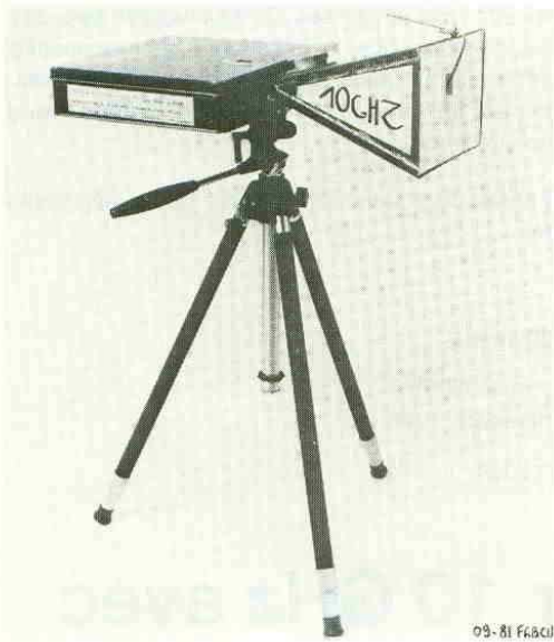
FIGURE 1. Emetteur-récepteur 10 GHz avec mélangeur à diode 1N23E et diode Gunn CXY11C.
