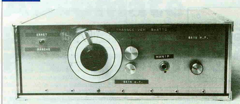
PHOTO 3 Transceiver QRP de 5 watts CW construit à l'ARD en 1996.
