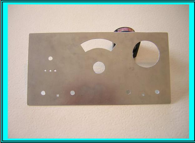
Voici l'exemplaire de la façade fabriqué en tôle d'aluminium épaisseur 1.5 mm aux dimensions de 30 x 15 cm origine Conrad modélisme pour la version N°2, transceiver QRP CW 40 m
