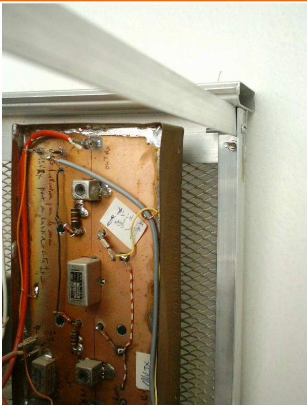
F.I. émission ou réception côté filtre à Quartz 10.7 MHz ; commutation par diodes 1N4148
