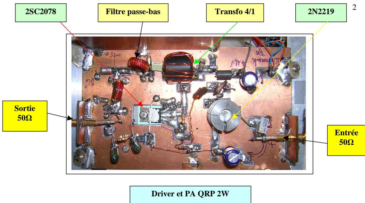
Voici figure 8 le schéma du driver et du PA QRP. Cet ensemble a fait ses preuves dans la version 2003 d'un transceiver QRP SSB 80 m. La puissance de sortie est d'environ 2 W. Nous avons laissé les filtre passe-bas de sortie, ce qui viendra à augmenter la pureté spectrale au moment de l'attaque du PA de 20/25 W HF.
