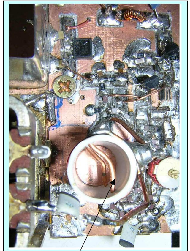
Vue intérieure de L et sa fabrication traversées en fil de cuivre 15/10<sup>ème</sup>
