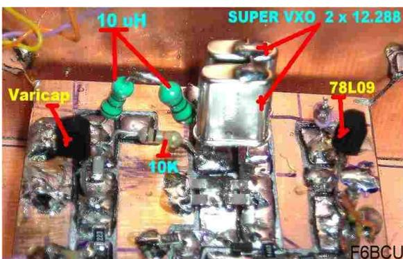
Les 2 bobinages de 10 uH sont disposés presque verticalement, pour le minimum de capacité par rapport à la masse.
