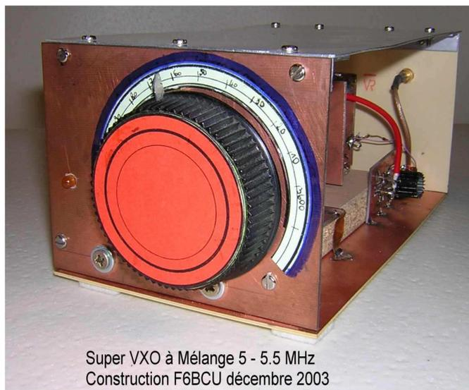
La construction du premier **super VXO mélangeur** date du printemps 2003 la stabilité obtenue est remarquable dans le temps ; à ce stade de stabilité le V.F.O. est surpassé. La variation de fréquence de 100 KHz utilisable est largement suffisante pour un trafic amateur, la possibilité de changement de segment de bande de fréquence étant relativement simple par simple échange de quartz.
