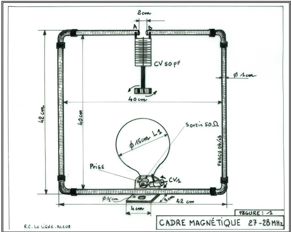
Le condensateur variable est soudé aux extrémités des tubes à l'aide d'un fer à souder d'au moins 100 watts. L'opération de soudage terminée la rigidité est très suffisante pour faire tourner les lames du condensateur variable de l'antenne fixée sur son support sans aucune flexion. Et nous obtiendrons un carré de 42 x 42 cm comme sur la figure 1 et la photographie de présentation du cadre en tête de l'article.
