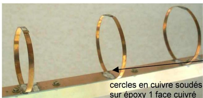
Le centre du feuillard cercle Loop en cuivre est soudé sur le côté cuivre du boom
