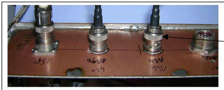
Partie arrière du commutateur pour les 3 transverters sortie sur BNC, pour le décimétrique ou 50 MHz sorties sur PL
