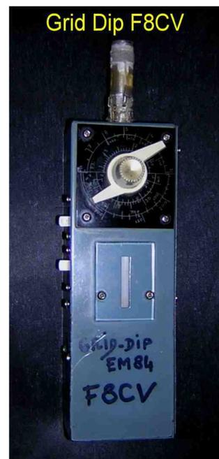
propre construction. L'appareil est sérieux, d'une construction facile, son origine est tirée du Handbook de l'ARRL. On en trouve la trace dans l'édition de 1982 et sa description perdue au-delà de 1989. Une modification intéressante a été ajoutée au schéma d'origine, c'est la possibilité de brancher un fréquencemètre sur le Dip-mètre et d'en faire un ensemble de tests et mesures universels.
