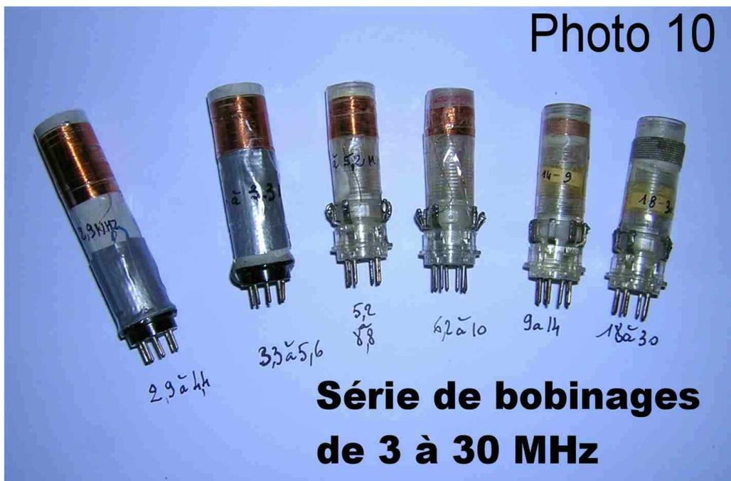
Le jeu complet de bobines de F6BCU pour couvrir de 3 à 30 MHz
