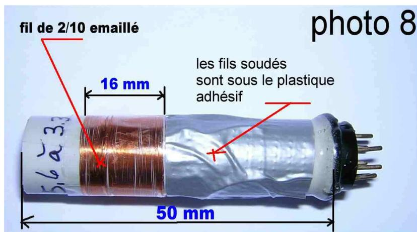
Il faut bien observer la photographie 8, les fils qui sortent du support, assemblés et soudés en préalable sont ensuite soudés en finalisation avec les fils de sortie de la bobine de 16 mm spires jointives en fil 2/10<sup>ème</sup> émaillé. (recouverts de plastique isolant pour la finition)
