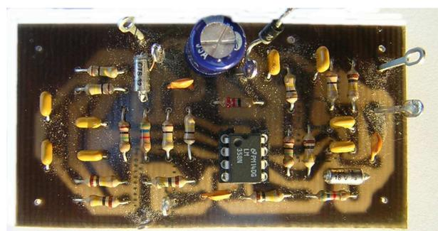
Le circuit imprimé du filtre CW
