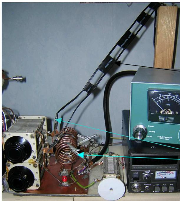
Voici l'arrivée du Feeder bifilaire sur le coupleur avec la bobine 20 m
